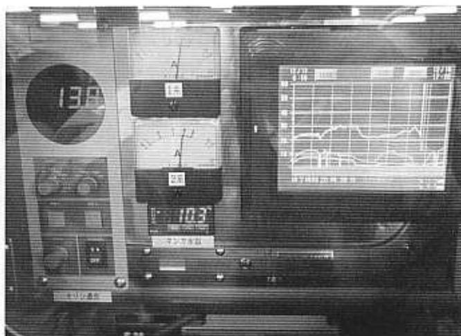
写真2 HACCP対応溶存オゾン濃度履歴計測システム部
