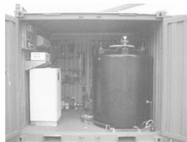
写真6. ナノピコオゾン水™生成装置
